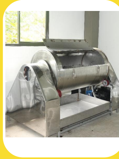
Equipo secador de panela pulverizada por infrarrojos
